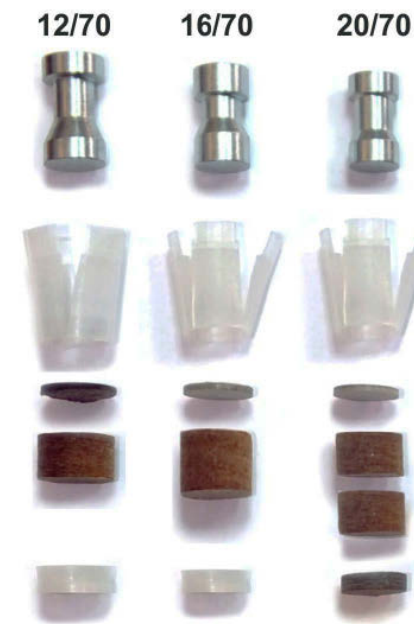
Схема сборки патронов
