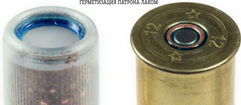
ГЕРМЕТИЗАЦИЯ ПАТРОНА ЛАКОМ
